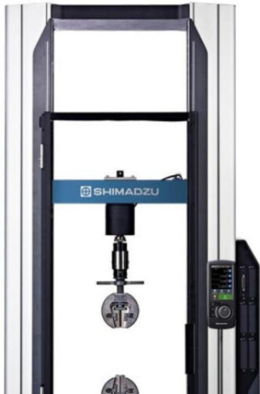
Die Universalprüfmaschinen der Serie AGX-V2 bieten den idealen Rahmen für alle Prüfanforderungen. Erhältlich als Standprüfmaschine in den Modellvarianten 50kN, 100kN, 300kN und 600kN sowie als Tischprüfmaschine in den Modellvarianten 10kN, 20kN und 50kN.
